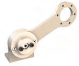
Der Federarm ist optimal geeignet, um in Kombination mit Messrad und Drehgeber bei einem höheren Federweg eine präzise und zuverlässige Längenmessung zu gewährleisten. Durch die 6 Befestigungsbohrungen die um jeweils 60° versetzt auf einem Teilkreis von 48 mm angebracht sind, ist eine optimale Ausrichtung und Montage des Drehgebers sichergestellt.
