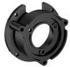
Kunststoff glasfaserverstärkt, thermisch und elektrisch isolierend. Drehgebermontage: wahlweise mit 3 Schrauben oder mit 3 Befestigungsexzentern, für alle Drehgeber mit Synchronflansch geeignet.
